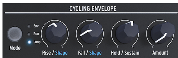
El Generador de Envolvente Cíclica
